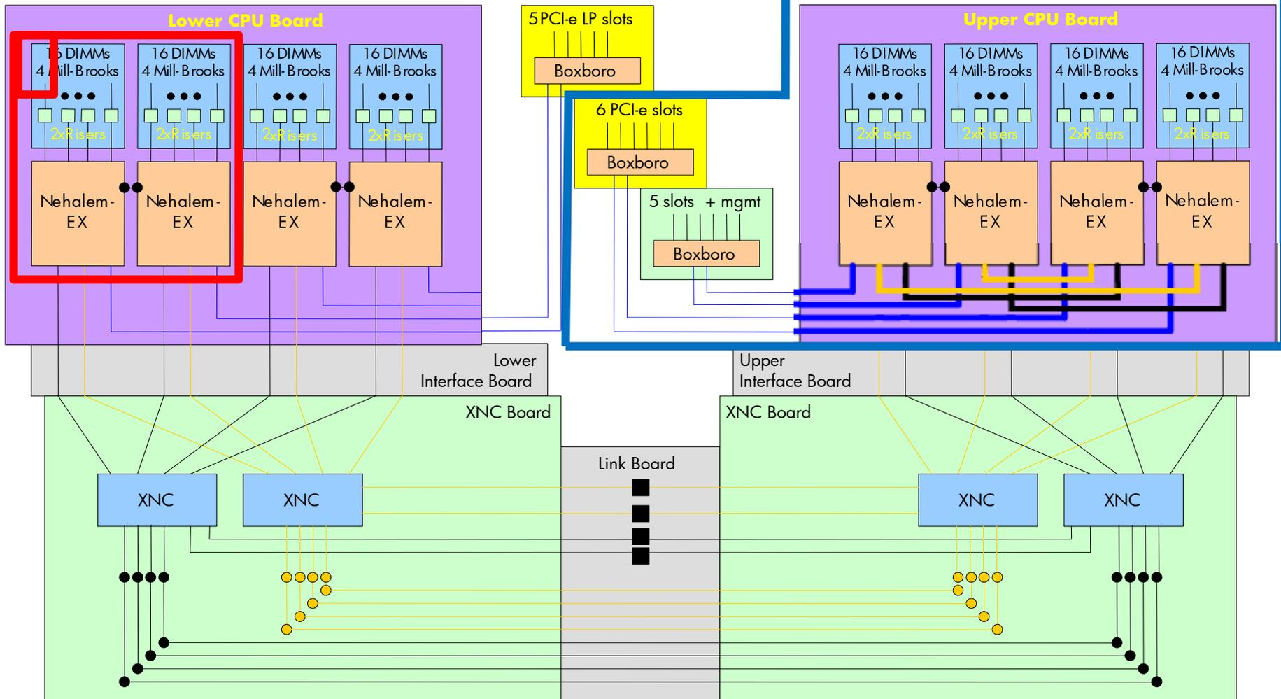
XNC-контроллер: коммутатор QPI + хранитель информации о кэшах
