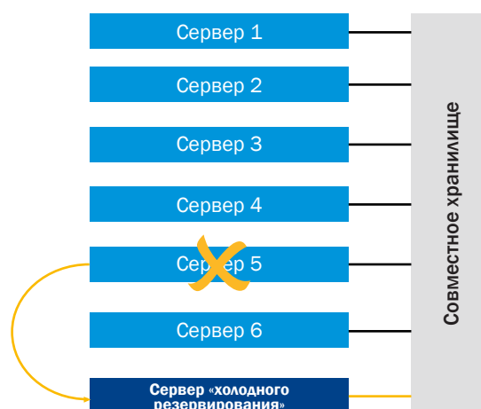
Рис. 3. Распределенная система: несколько узлов, использующих совместное хранилище данных для распределения рабочей нагрузки
